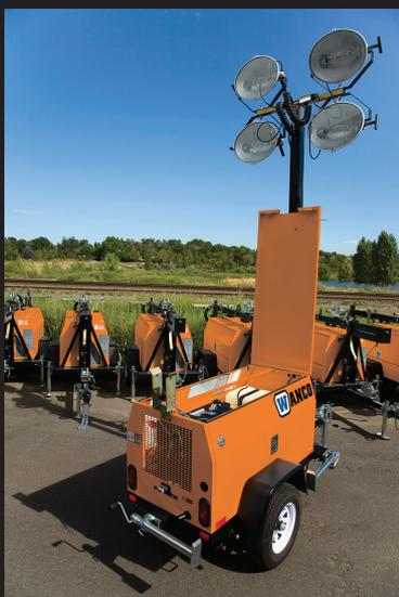
Верхняя панель полностью откидывается и может быть зафиксирована для технического обслуживания.
