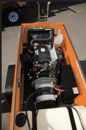
Подняв верхнюю панель можно получить полный доступ к двигателю и другим компонентам. Расширить доступ можно, сняв боковые панели.
